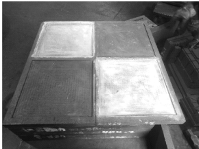
图 3 薄板的石墨型图片 Fig.3 Graphite mold for thin plate
